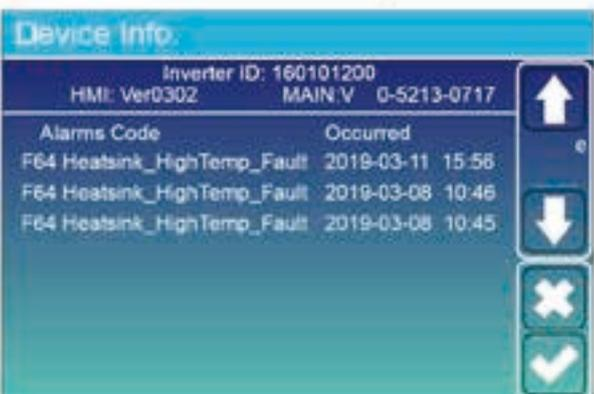
Auf dieser Seite werden die Wechselrichter-ID, die Wechselrichterversion und die Alarmcodes angezeigt.
