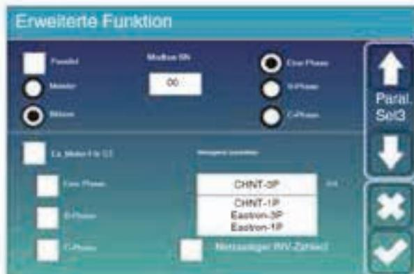
**Ex\_Meter Für CT:** Klicken Sie in einem Dreiphasensystem mit CHNT-Dreiphasen-Energiezähler (DTSU666) auf die entsprechende Phase, an die der Hybridwechselrichter angeschlossen ist. Wenn der Ausgang des Hybridwechselrichters beispielsweise mit der A-Phase verbunden ist, klicken Sie bitte auf A-Phase.
