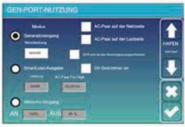
**Nennleistung des Generators:** zulässig max. Strom vom Dieselegenerator.
