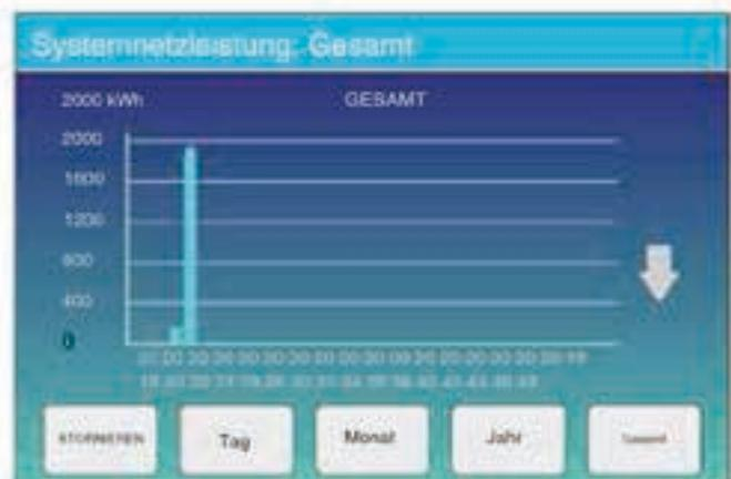
Die Solarstromkurve für Tages-, Monats-, Jahres- und Gesamtenergie kann grob auf dem LCD überprüft werden. Für eine genauere Stromerzeugung überprüfen Sie bitte das Überwachungssystem. Klicken Sie auf den Aufwärts- und Abwärtspeil, um die Leistungskurve verschiedener Zeiträume zu überprüfen.
