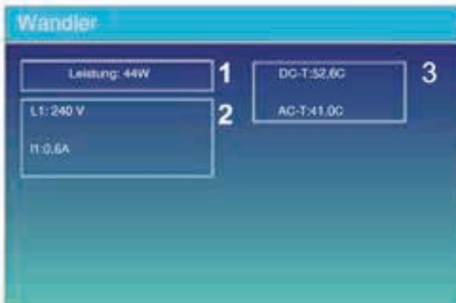
Dies ist die Wechselrichter-Detailseite
